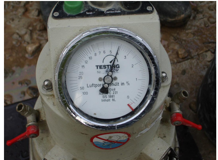
Gaisa saturs noteikšana svaigam betonam
