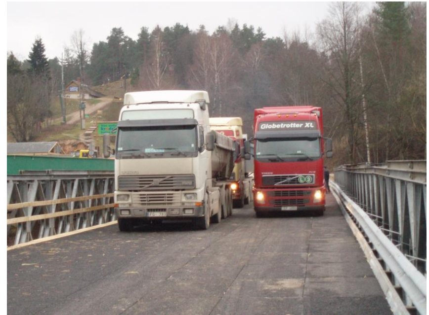
Pagaidu tilta statiskā slogošana pirms atklāšanas satiksmei
