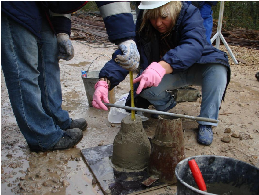
Konusa nosēduma noteikšana svaigam betonam
