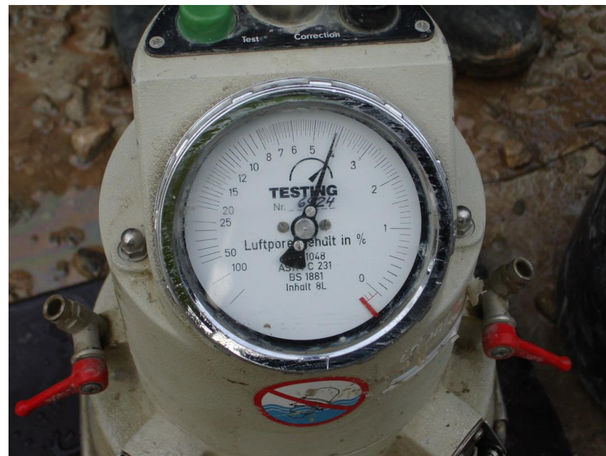
Gaisa saturs noteikšana svaigam betonam
