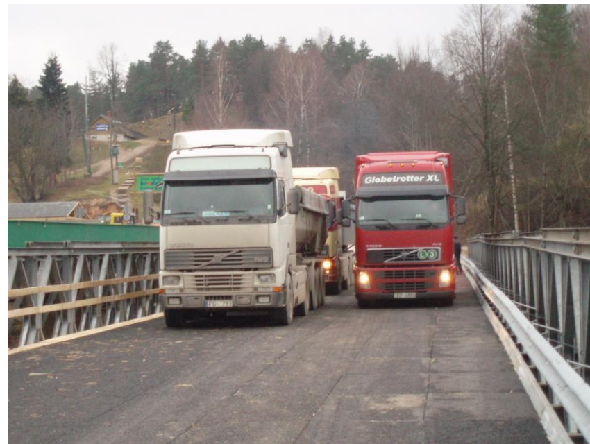
Pagaidu tilta statiskā slogošana pirms atklāšanas satiksmei
