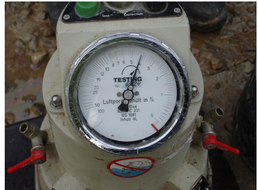
Gaisa saturs noteikšana svaigam betonam
