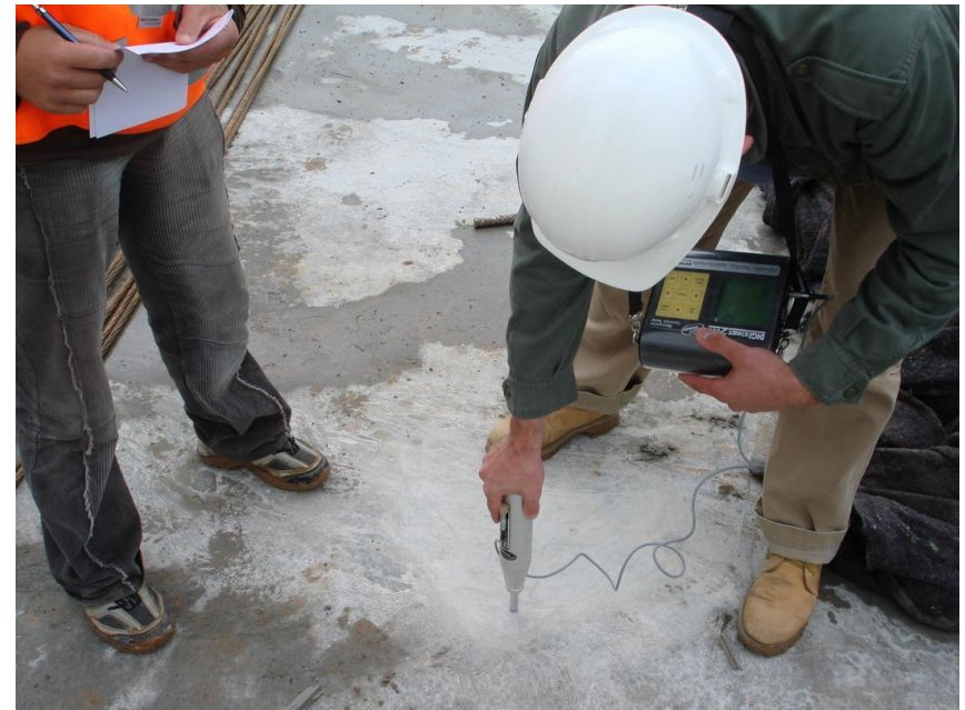
Betona stiprības pārbaude ar Šmidta āmuru
